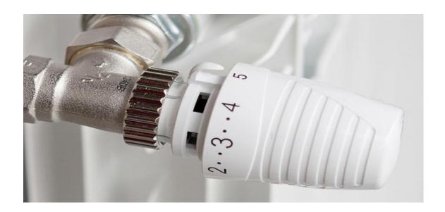
Son válvulas de regulación de caudal de agua, que, junto con el cabezal termostático, consiguen regular la temperatura de cada una de las zonas de la vivienda, cerrando el paso de agua al radiador cuando se alcanza la temperatura ajustada, ayudándole a reducir aprox. el 20% del consumo de energía.
